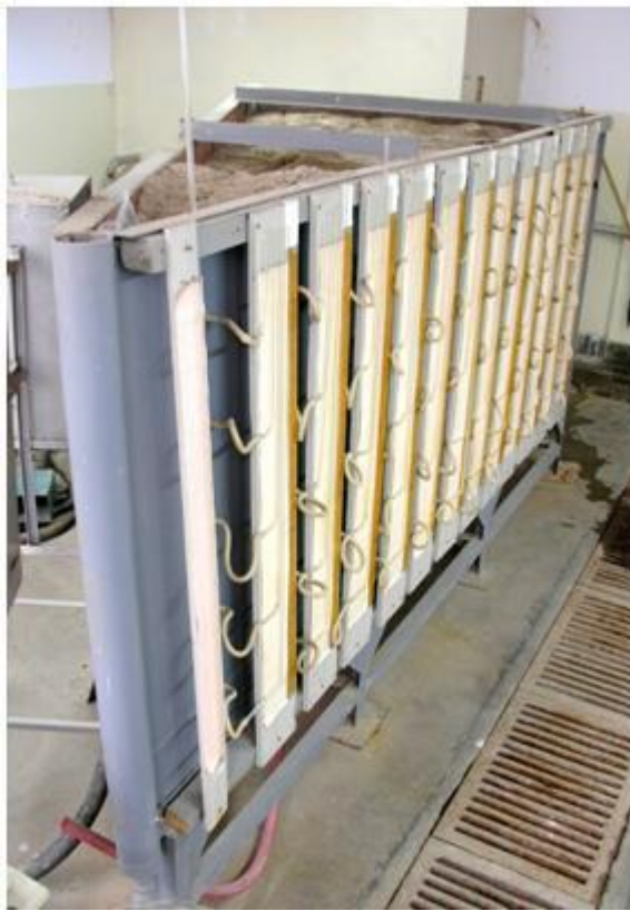
图为扇形渗流槽，用于模拟井流，训练学生掌握抽水试验测定 K 的方法。
